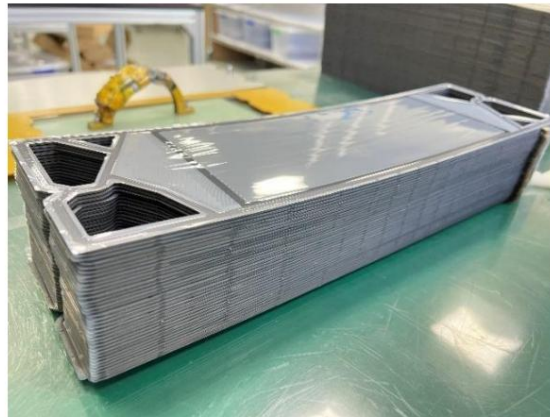
Fig. 4 Células individuales terminadas, placa bipolar incluyendo MEA.
